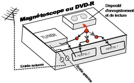
La sortie antenne de votre enregistreur (magnéscope ou DVD-R) permet de brancher en cascade l'entrée antenne de votre téléviseur. Vous pouvez choisir manuellement la chaîne que vous souhaitez enregistrer, mais également choisir d'enregistrer l'appareil branché sur la PERITEL 1 ou la PERITEL 2.
