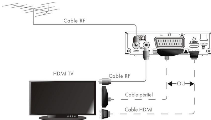
**Entrée «ANT IN» :** A connecter à votre antenne «râteau» de votre toit, à votre antenne d'intérieur ou à votre arrivée d'antenne si vous êtes câblé.
