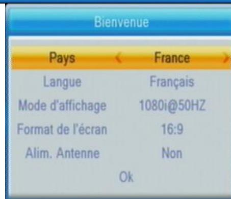
11)A l'aide des touches **CH▲** et **CH▼** sélectionnez la ligne « **OK** » tout en bas et appuyez sur la touche **OK** de la télécommande : la recherche des chaînes démarre automatiquement.
